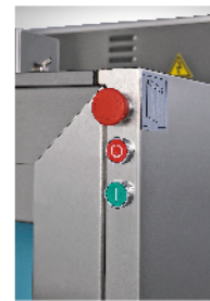
入口及出口皆有 緊急停止和啟動開關
