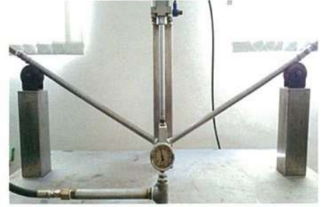
耐壓試驗、水壓試驗、彎曲試驗 (水壓加至25kgf/cm 2 )
