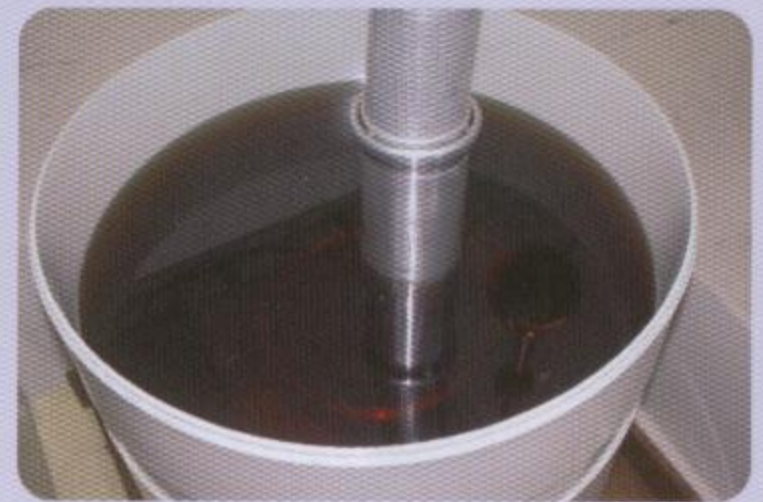
Durchführung der TE-Prüfung unter Öl (Shell Diala D) Testing of PD under oil (Shell Diala D)
