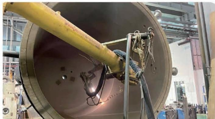
焦油蒸發器桶槽噴焊
