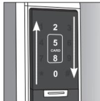
同時藍色數字鍵亮起，並且成一直線顯示，表示門已上鎖，而且防盜功能已設定連線完成。
