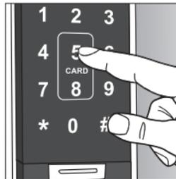
輸入密碼 6 位數後再按 #，聽到“密碼設定完成”語音，表示新密碼已設定完成，同時藍光熄滅。
