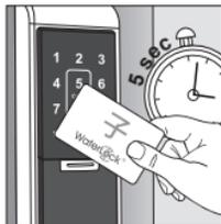
卡片不離開感應區持續感應約 5 秒後，先聽到語音“門已上鎖”；然後再響一長聲，藍色燈號亮起，表示防盜功能已設定連線完成。
