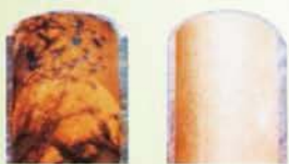
潔磷晶處理前後 熱交換器對照表
