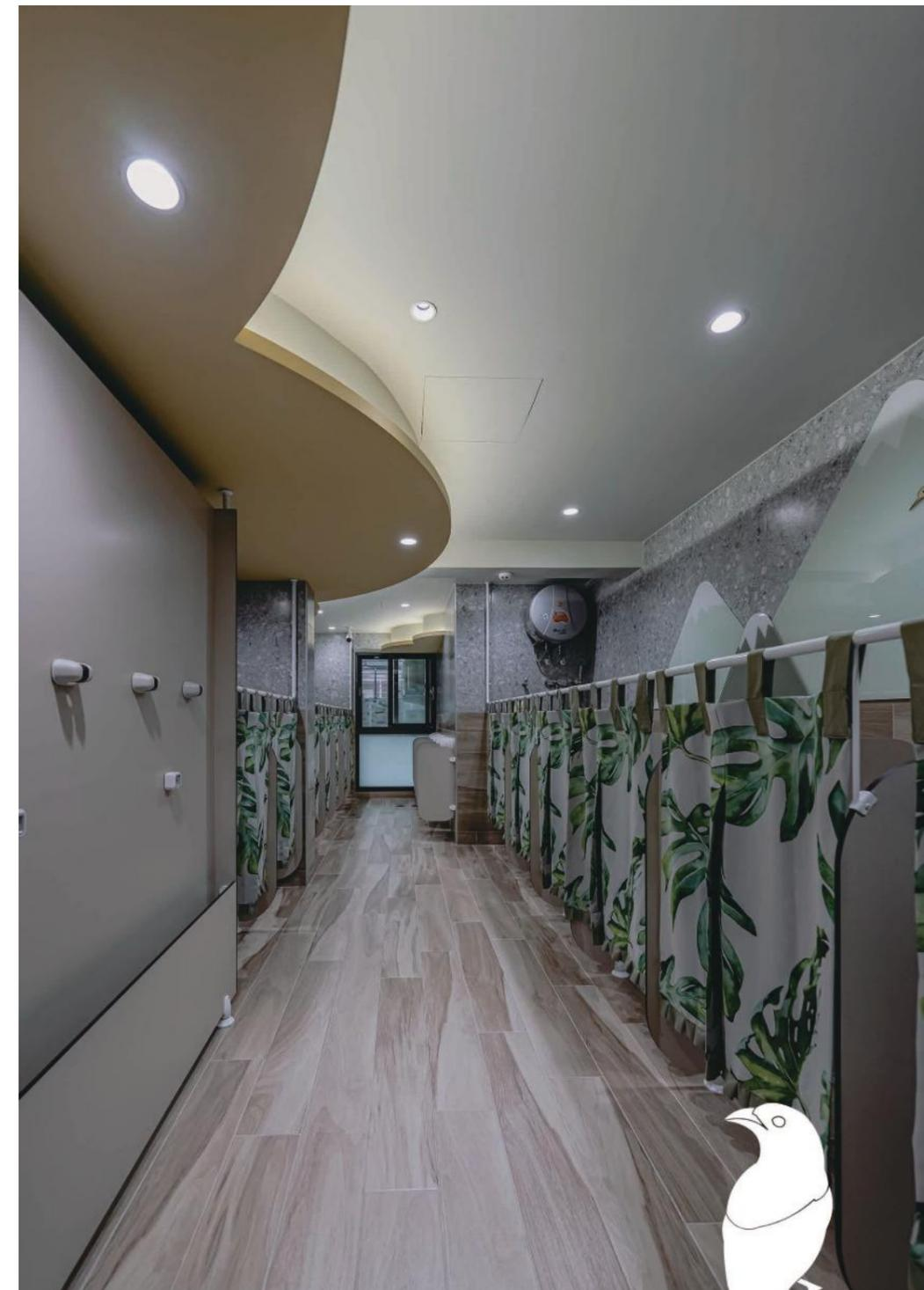
拆除內部隔間，把原本兩間教室整併為一大室，並把原本內部進出的廁所入口改到走廊上，直接對外，提升共同使用性；並利用走廊的流通性，沿建築外牆設置L型洗手槽，牆上一側貼上明鏡，另一側的開窗則貼上單面鏡，從室內可看間室外情況，使老師便於掌握孩子的狀況，融入安全性的考量。
