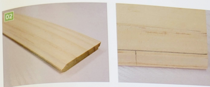
準備一片厚 9mm 的木板，長度大於兩個把手長，寬度為操作修邊機時方便施打 的寬度即可。
