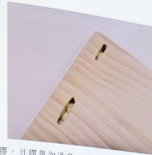
33 膠合時，每個接著面都須確實的塗上膠，且膠量勿過多。當膠擠太多時，在組合後會發生溢膠的情況，這時會造成已打磨完成的內部沾上膠，因打磨不易，所以無法清除乾淨。
