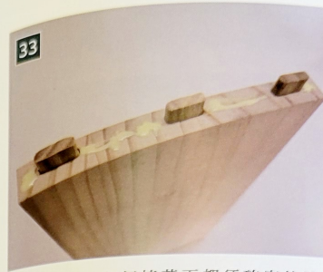
33 膠合時，每個接著面都須確實的塗上膠，且膠量勿過多。當膠擠太多時，在組合後會發生溢膠的情況，這時會造成已打磨完成的內部沾上膠，因打磨不易，所以無法清除乾淨。
