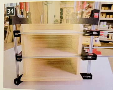
34 組合好後，務必使用夾具將其固定至膠乾。夾持完畢後，務必檢查櫃體是否有變形，由於抽屜櫃內部還有抽屜，所以外框務必精準。
