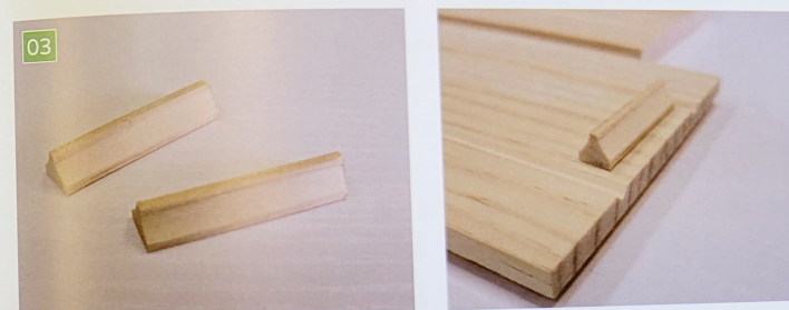
裁切完後，進行細部砂磨，底部黏合處保持平整。完成後即可直接上膠黏合於門 片上。
