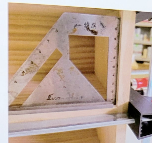
34 組合好後，務必使用夾具將其固定至膠乾。夾持完畢後，務必檢查櫃體是否有變形，由於抽屜櫃內部還有抽屜，所以外框務必精準。
